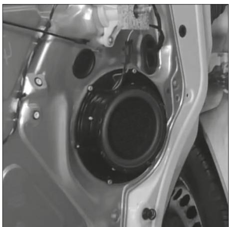
Entfernen Sie den Original-Lautsprecher. Dieser ist am Aufnahmerring sechsfach vernietet. Bohren Sie die sechs Nieten auf und entfernen diese komplett aus den Löchern.
