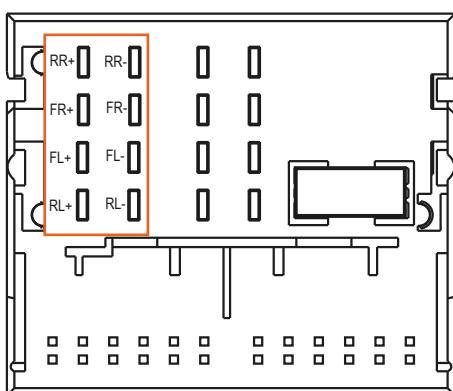
Verbinden Sie nun entsprechend die verlegten Lautsprecherkabel der Hochtöneinheiten mit den Kabeln auf der Rückseite des Quadlock-Steckers. Beachten Sie dazu die Belegung des Quadlock-Steckers links.
