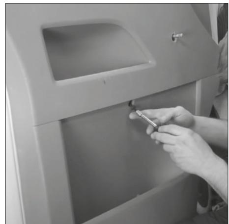
Befestigen Sie den Lautsprecher mithilfe einer Handnietzange und sechs geeigneten Nieten.
