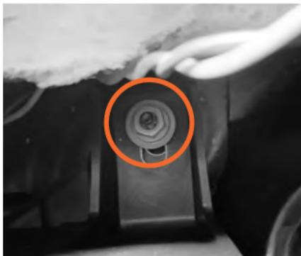
Lösen Sie diese Schraube der Fußraumabdeckung.
