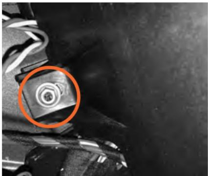
Lösen Sie diese Schraube der Fußraumabdeckung.
