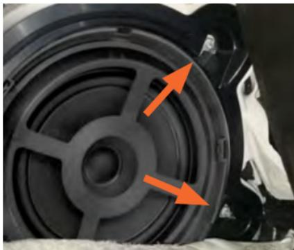
Entfernen Sie die Abdeckung des Fußraums, um Zugang zum Einbauplatz des Subwoofers zu haben.
