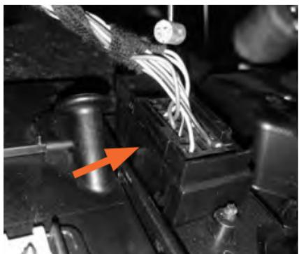
Entriegeln Sie den schwarzen Stecker indem Sie die Verriegelung nach hinten schieben.
