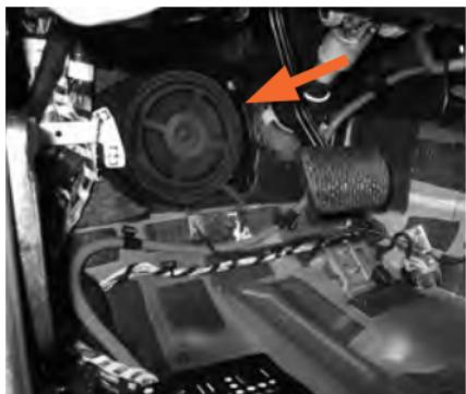
Beginnen Sie auf der Fahrerseite. Der Subwoofer befindet sich hinter der Abdeckung hinter den Pedalen.
