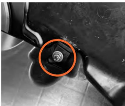
Lösen Sie diese Schraube der Fußraumabdeckung.
