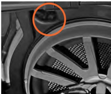
Schrauben Sie abschließend den Musway Subwoofer CSM206WR mit den drei Schrauben fest und stecken den Verbindungsstecker ein.
