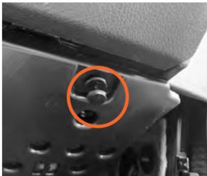
Entfernen Sie die rechte Plastikhalterung unterhalb des Armaturenbretts im Fußraum der Beifahrerseite.
