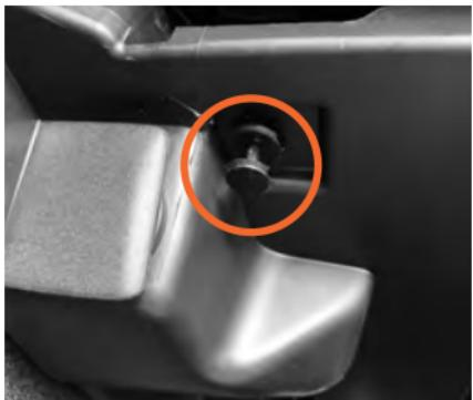
Entfernen Sie die linke Plastikhalterung unterhalb des Armaturenbretts im Fußraum der Beifahrerseite.
