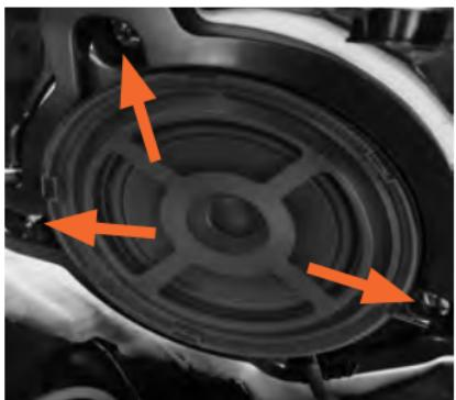
Der Subwoofer ist an drei Punkten verschraubt. Lösen Sie alle drei Schrauben und legen diese beiseite.
