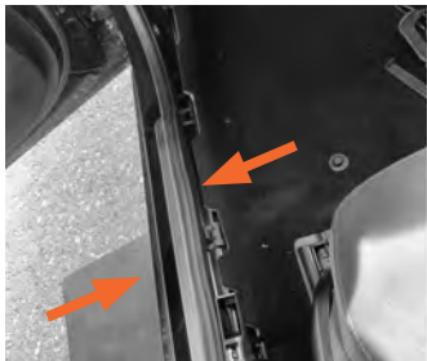
Entfernen Sie zuerst vorsichtig die Verkleidung innen an der Türschwelle. Diese ist nur eingeklipst.
