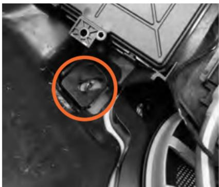
Entfernen Sie die Abdeckung des Fußraums und die Schrauben des Steuergeräts, um Zugang zum Einbauplatz des Subwoofers zu haben.
