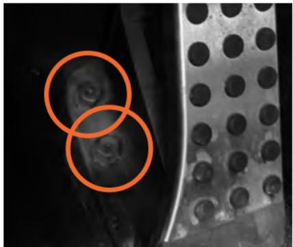
Entfernen Sie die beiden Schrauben unterhalb des Gaspedals.
