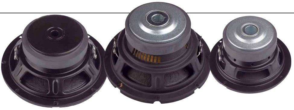
Der MF-Woofer (links) baut deutlich flacher als der 20er im MR108Q (Mitte). Alle Woofer haben solide Blechkörbe und gepresste Polkerne, die 20er arbeiten mit 2 x 2-Ohm-Doppelschwingspulen
