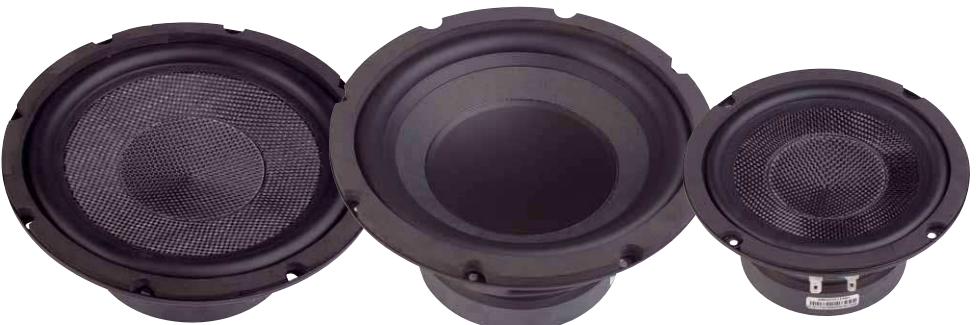
Der MF-Treiber (links) und der 16er arbeiten mit glasfaserverstärkten Membranen, beim MR108Q kommt klassisch Papier zum Einsatz
