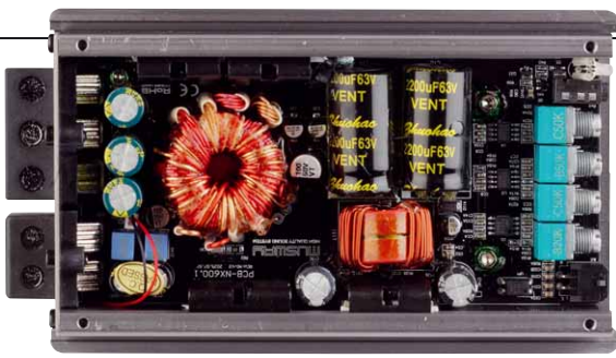
Die Mono NX600.1 bietet 600 Watt auf 15 Zentimetern. Entsprechend kräftig sind Pufferung und Tiefpassspule dimensioniert
