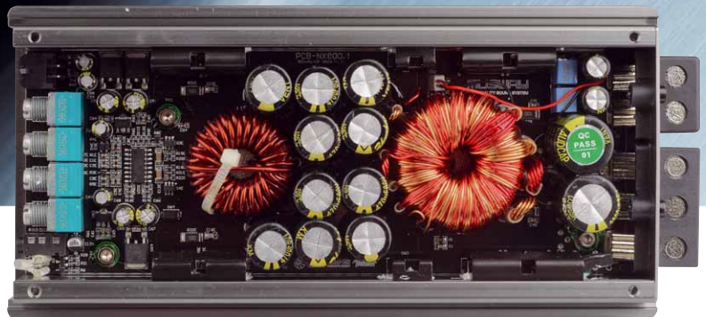
Trotz der kompakten Größe gibt es kräftige Netzteil- und Filterspulen
