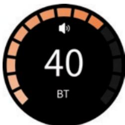
Drehen Sie myCON, um die Bluetooth®-Eingangslautstärke anzupassen. Die Bluetooth®-Lautstärke wird mit der Lautstärke des Telefons synchronisiert.
