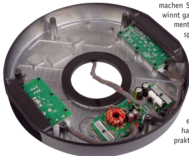
Anschlüsse, Signaleingang und Class-AB Endverstärkung sitzen auf separaten Platinen
