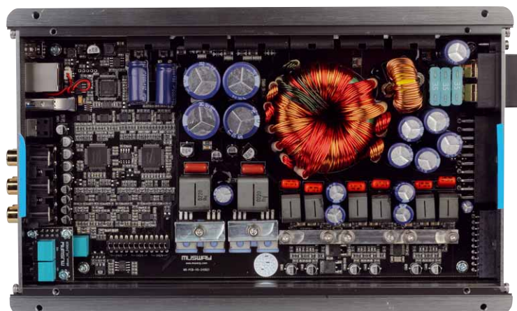
Die Verstärkung bietet zwei große Kanäle mit externen MOSFETs und 6 kleine Kanäle, verteilt auf 3 Verstärker ICs
